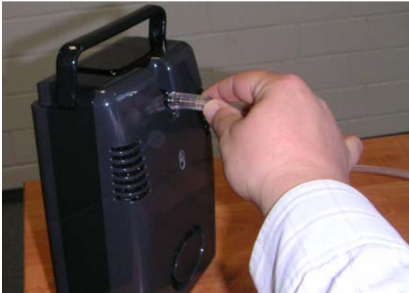
Abb 7: Verbinden der Kanüle mit der Sauerstoffaustrittsöffnung des FreeStyle-Gerätes
