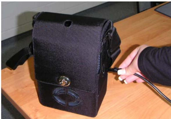
Abb. 5: Aufladen der internen Batterie
