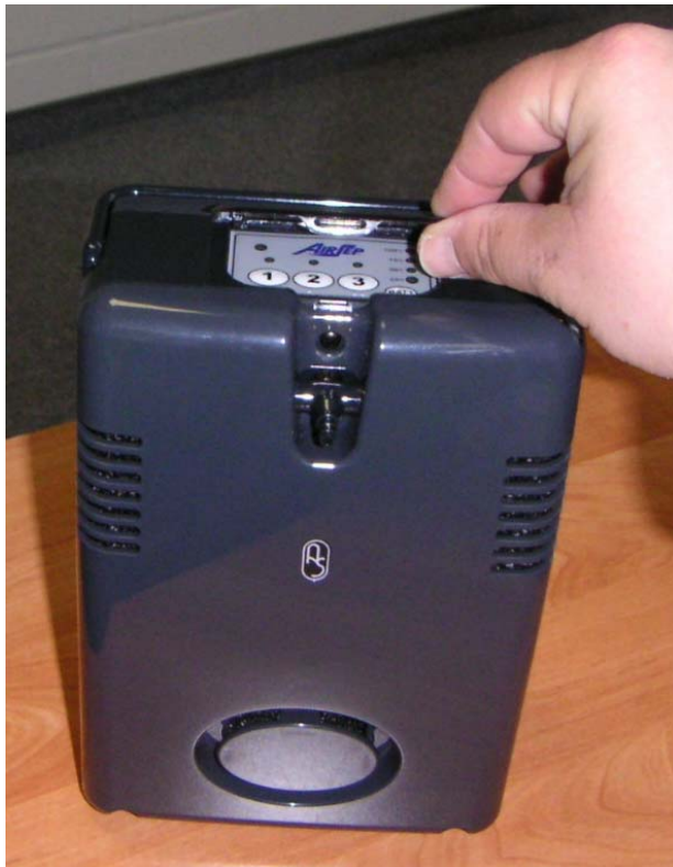
Abb. 13: Öffnen der Staubschutzklappe des Bedienfeldes
