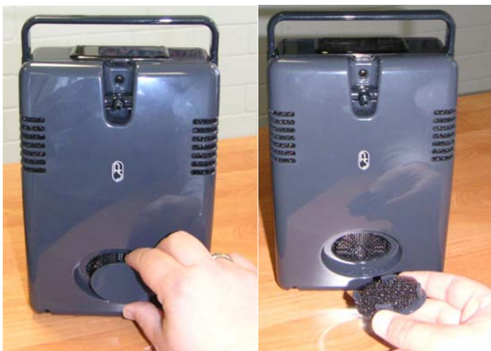
Abb. 11: Entfernen des Luftzufuhrfilters / Filter-Deckels
